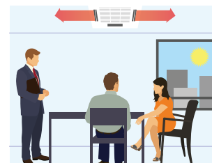
Режим непрямого потока воздуха при обнаружении движения
